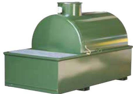
Serbatoio cilindrico per lo stoccaggio di olio esausto. Struttura in acciaio al carbonio con trattamento esterno anticorrosione, bacino di contenimento in acciaio al carbonio con grigliato. Dotato di passo d'uomo di carico con coperchio ribaltabile, rete scolafiltro e indicatore di livello visivo.
