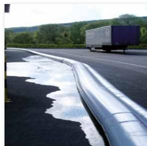
Barriere gonfiabili in polietilene utilizzabili sia in acqua che a terra; vengono fornite arrotolate su di una bobina per un rapido e semplice srotolamento nelle situazioni di emergenza. Il tessuto di cui è costituita la barriera è un polietilene ad alta resistenza capace di resistere agli strappi, ai prodotti chimici, agli UV.
