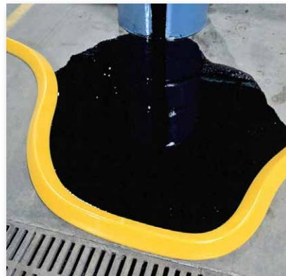
**■ ■** Digues de confinement réalisées en technopolymères afin d'endiguer ou rediriger les fuites accidentelles des liquides polluants. Grâce à sa flexibilité, la digue peut être utilisée dans de diverses situations. Le tapis peut être réutilisé. Après l'utilisation il suffit de le nettoyer avec de l'eau et du détergent commun.
