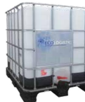
Contenitore IBC concepito per il trasporto su strada, ferrovia e via mare di prodotti liquidi pericolosi e non. È costituito da una gabbia tubolare in acciaio zincato assicurata ad un pallet che racchiude un otre in PE. Disponibile nella versione con pallet in polietilene o in legno.
