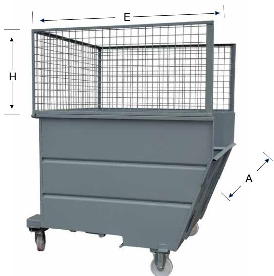
**■ ■** Sovrasponda in rete, maglia 50x50 mm filo diametro 4 mm con telaio perimetrale in L da 35x20 mm per benne.
