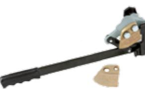
Cesoaia per la rimozione dei coperchi dei fusti metallici. Costruita in acciaio. Regolabile a seconda della durezza del materiale e il bordo dei fusti.
