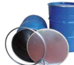
Fusto metallico ad apertura totale. Coperchio asportabile. Anello di chiusura a leva. Interno grezzo. Colorazione standard manto blu RAL 5010. Con fondo e coperchio zincati. spessore 7-9/10 mm. Possibilità di INTERNO LACCATO per fusti da 60 o 220 lt.
