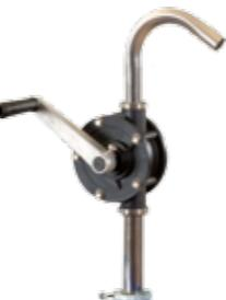
Articolo 2C000654: Pompa rotativa per liquidi chimici corrosivi, ideale anche per liquidi alimentari. Costruita in Ryton (PPS), acciaio INOX Aisi 304 e Teflon. Tubo in uscita: diametro 25 mm (1"). Tubo costituito da 3 parti (lunghezza 330 mm. cad).
