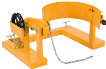
Ribalta fusti con catena di sicurezza che permette all'operatore di effettuare il ribaltamento senza scendere dal mezzo. L'operazione di svuotamento del fusto avviene tramite catena. Struttura in acciaio verniciato a polvere. Max. dimensione di entrata delle forche 180 x 65 mm, distanza dal centro dell'entrata delle forche: 620 mm. Adatto alla movimentazione di fusti in ferro. Dimensioni mm: 680 x 535 x 995. Fornito completo di marcatura CE e certificato di conformità.
