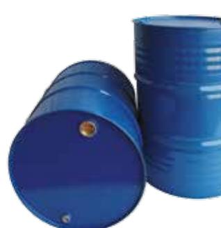
Fusto metallico ad apertura parziale. Tappi Tri-Sure 1 x 2" e 1 x 3/4", Interno grezzo. Colorazione standard blu RAL 5010. Fusto in ferro da 217, 30 o 60 lt - isocontainer con corrugazioni - spessore 7-9/10 mm - omologato
