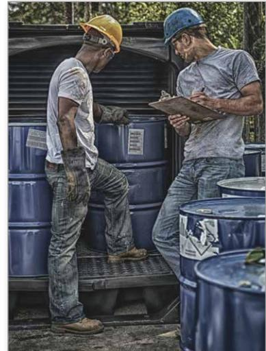
**Bac de rétention en polyéthylène recyclé particulièrement indiqué pour un stockage sécurisé des fûts pour la récupération des liquides polluants. Excellente résistance aux agents chimiques et résistant à la plupart des acides, des bases et des huiles. Structure légère et très durable. Il peut être levé avec des chariots élévateurs et avec transpalettes. Essais de chargement: RINA.**
