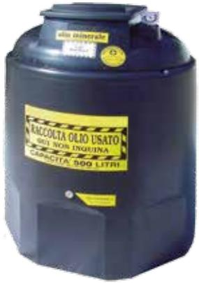
**ITALIA** Serie di contenitori brevettati per la raccolta differenziata di olio MINERALE esausto. Realizzati in polietilene, di colore nero, con vasca di sicurezza incorporata (doppio contenitore), dotati di cestello scolafiltro asportabile di forma rotonda, inglobato nel boccaporto protetto da coperchio circolare, e di vano per l'immissione e l'estrazione dell'olio minerale esausto.
